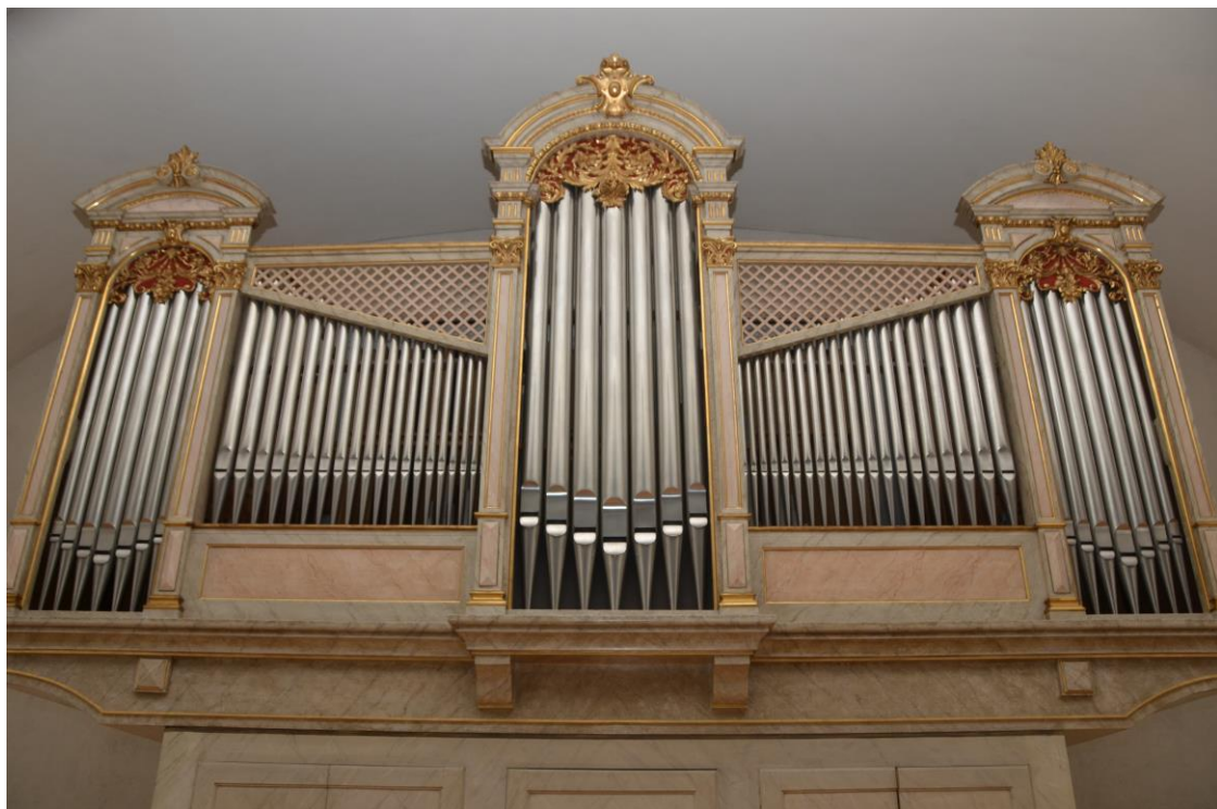
Orgel Pfarrkirche St. Hieronymus Elektrische Kegelladenorgel mit 22 Registern und 3 Transmissionen, 2-manualig, Baujahr 1956, Erbauer und Pflege durch Orgelbau Graf AG Sursee
