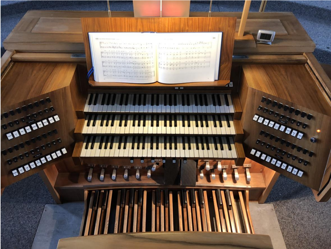
Orgel Pfarrkirche St. Maria in Weggis Mechanische Schleifladenorgel mit 4 Registern, 3-manualig, Baujahr 1970, Erbauer und Pflege durch Orgelbau GRAF AG Sursee
